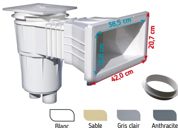
Skimmer grande meurtrière muni d'un volet avec amortisseur anti-bruit. Possibilité de régler la hauteur du cadre et du couvercle afin d'ajuster l'ensemble au niveau des plages. Sortie 1"1/2 - Sortie 2" - Trop plein D 32. Vis parker et joints autocollants Débit : 5 à 7 m<sup>3</sup>/h
