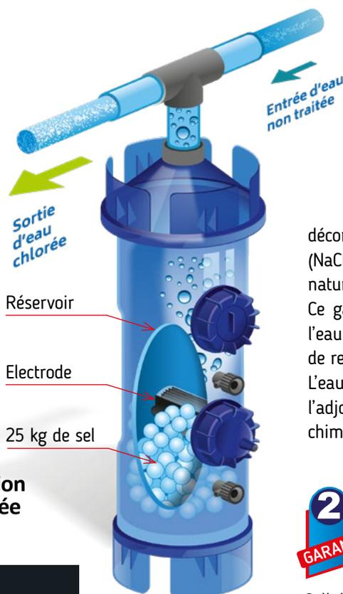
L'électrolyse CHLOR'IN décompose la molécule de sel (NaCl) pour former un chlore naturel à l'état gazeux. Ce gaz étant plus léger que l'eau est envoyé sur la ligne de refoulement de la piscine. L'eau est ainsi chlorée, sans l'adjonction de produits chimiques traditionnels.
