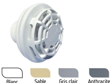
Se place en bas de paroi à environ + 15 cm du radier. Diamètre 98 mm - Extérieur à visser 2" - Intérieur 50 à coller Vis parker et joints autocollants Débit : 8 m<sup>3</sup>/h. (Installation par 2 de préférence)
