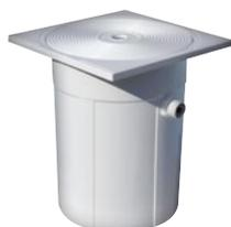
Maintient le niveau d'eau à bonne hauteur, entrée en 3/8 " Sorties F 50 mm à coller, mécanisme à flotteur, couvercle réglable en hauteur
