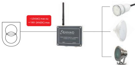
À n'utiliser qu'avec une alimentation ou un transformateur isolant de sécurité. Ne pas brancher en série. Protéger les connecteurs avec du gel isolant
